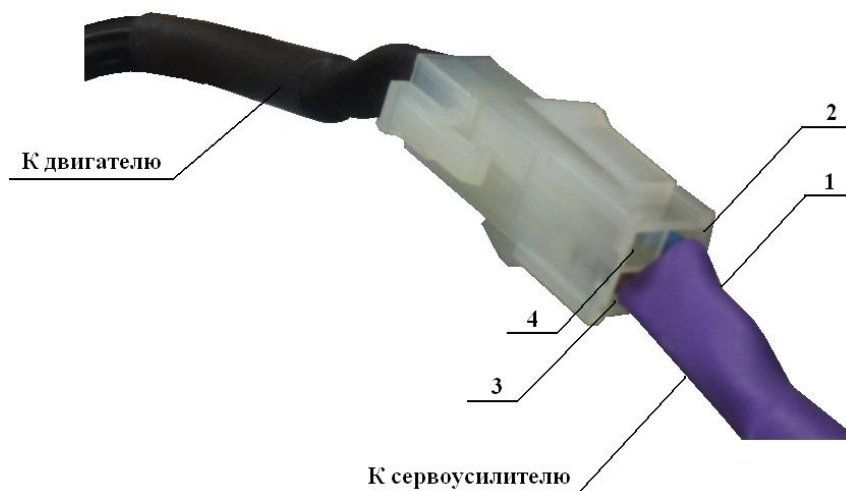
Рис. 10. Подключение силового кабеля серводвигателя к сервоусилителю СПС15.
